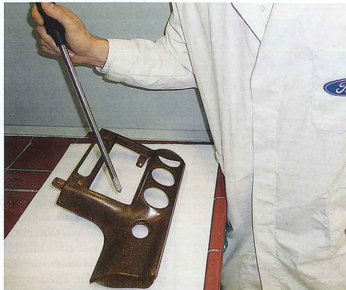
Ford arbeitet an einem Holz-Kunststoff-Verbund: Das künstliche Material ummantelt die Naturfasern und macht sie extrem haltbar
