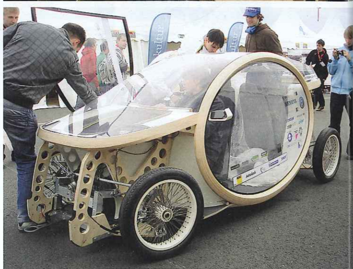
Alle tragenden Teile der Karosserie sind aus Eschenholz, ebenso das Armaturenbrett und die Sitze
