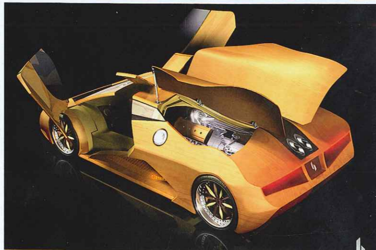
Eine Speziallüftung schützt das Holz vor der Hitze des 600-PS-Motors
