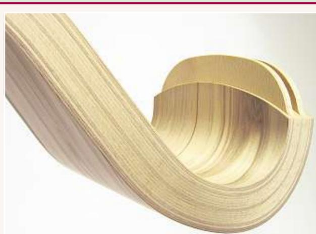
**Formteile aus Holz:** In der Möbelindustrie werden sie schon länger eingesetzt. Nun wird der Einsatz solcher Verbundwerkstoffe im Automobilbau erforscht. Foto: Fritz Becker KG
